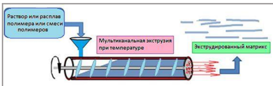
Рисунок 8 – Схема получения пористого матрикса экструзией.
