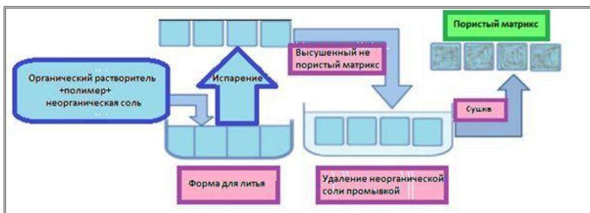
Рисунок 4 – Схема получения пористого матрикса с применением порообразователей.
